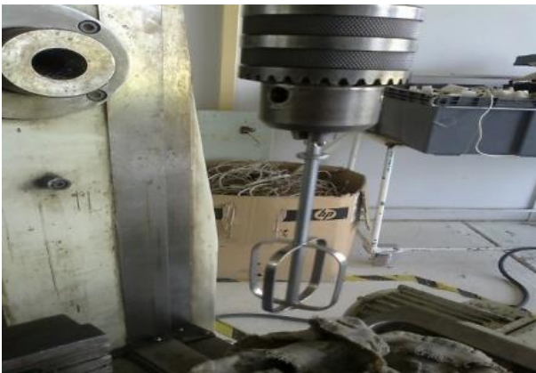
Figura 2 Agitador mecánico habilitado para el mezclado
